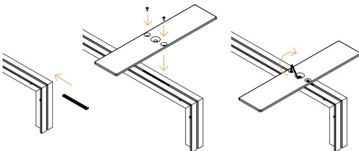
**D** Einbau der halben FlachfüÙe LN155-01
