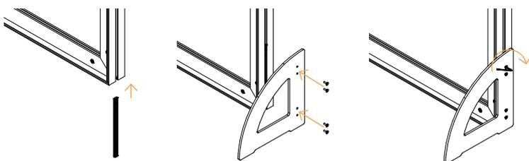
**B** Einbau der halbmondförmigen FüÙe SLF2
