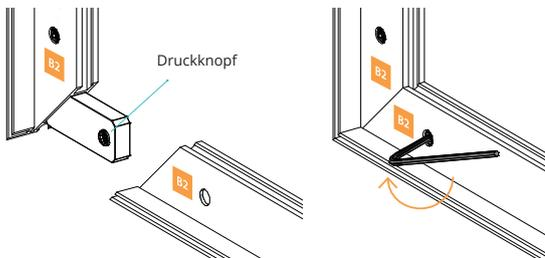
2 Zusammenbau von 2 geraden Abschnitten mit Hilfe der Montagemarkierungen
