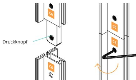
3 Zusammenbau einer Querverstrebung auf einem Rahmen mit Hilfe der Montagemarkierungen
